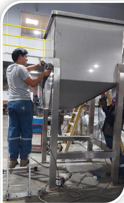
Fabricación de tolvas y estructuras metálicas
